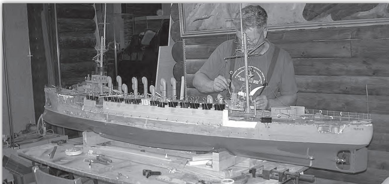
Фото № 1. Начальный период работы. Хорошо видно состояние корпуса и утрата фрагментов обшивки
